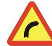
TP-13 a CURVA PELIGROSA HACIA LA DERECHA
