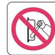
SP-190 PROHIBIDO ACCIONAR
